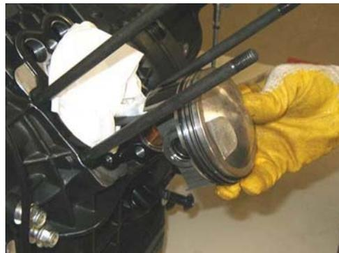
**Montage des Kolben****ANMERKUNG**
