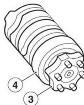
Die Schaltwalze auf Beschädigungen, Kratzer und Verschleißspuren überprüfen und gegebenenfalls die Schaltwalze auswechseln.
