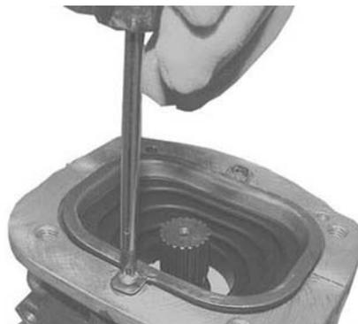
Die Öl-Einfüllschraube zusammen mit der Unterlegscheibe anbringen.
