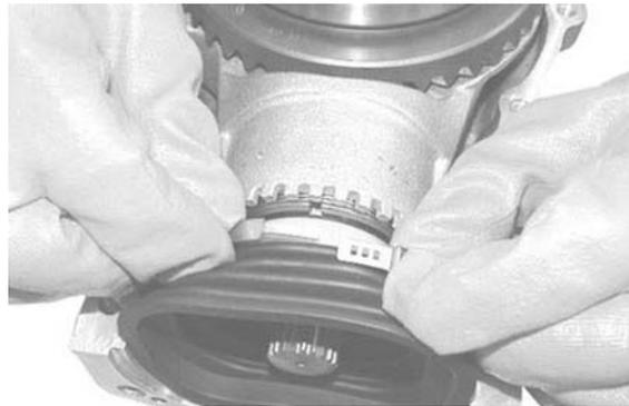
Die Schelle mit der entsprechenden Zange festziehen.
