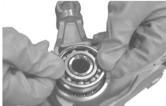
**Einbau der Gehäuseeinheit**
