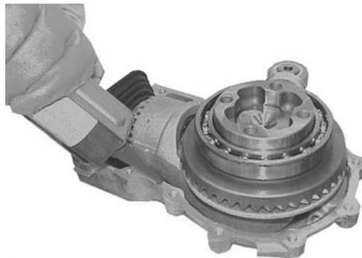
Einen neuen Dichtungsring mit dem Puffer einbauen.
