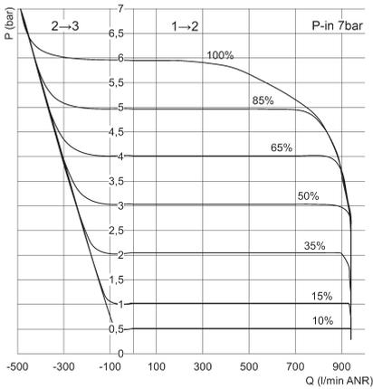
P = Geregelter Ausgangsdruck und Entlüftungsdruck
