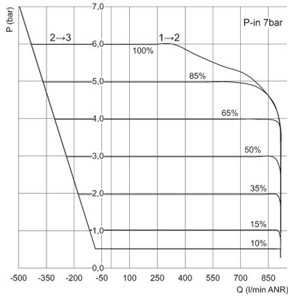
P = Geregelter Ausgangsdruck und Entlüftungsdruck
