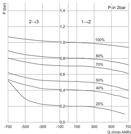
P = Geregelter Ausgangsdruck und Entlüftungsdruck
