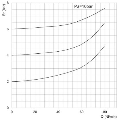
Pr = Ausgangsdruck
