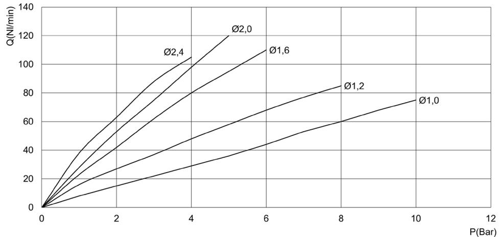
Werte beziehen sich auf jeweils max. Durchflusswerte/Pin [Elektromechanische Schaltzeit 10ms]
