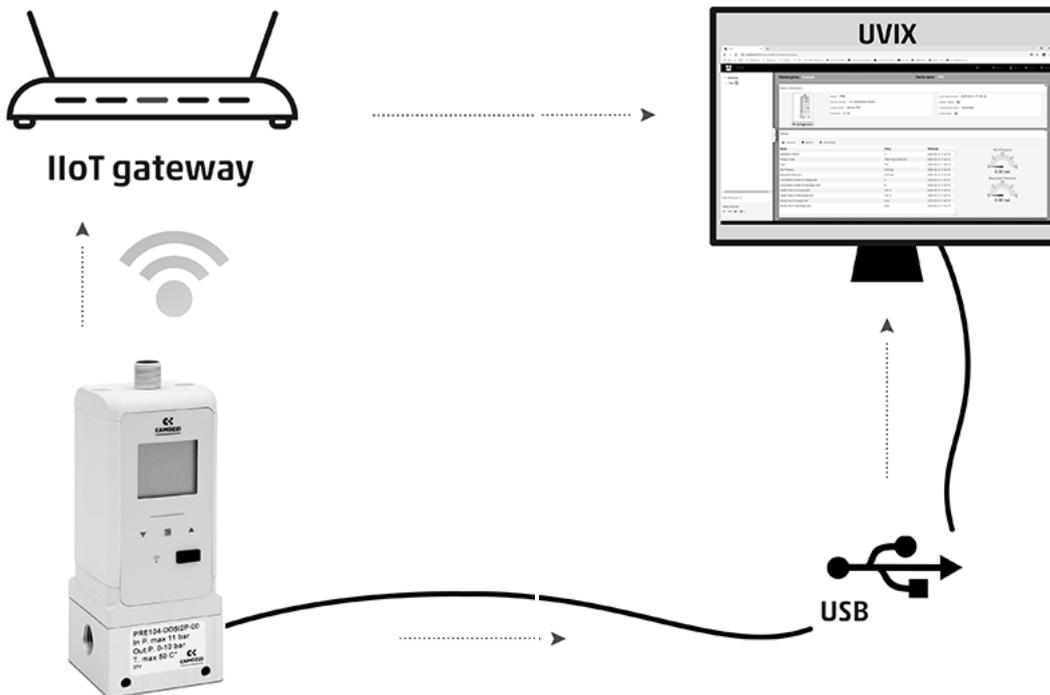
Die Überwachungsparameter beinhalten unter anderem die Temperatur und aktuellen Betriebsstunden des Reglers. Die gesammelten Werte können über die UVIX-Software angezeigt und visualisiert werden. Die Software ist kostenlos als Download im Camozzi Online-Katalog verfügbar.
