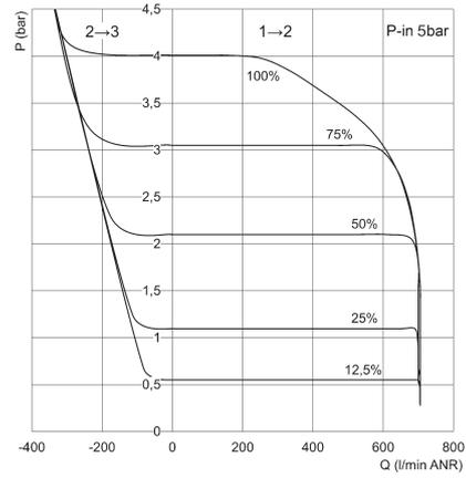
P = Geregelter Ausgangsdruck und Entlüftungsdruck
