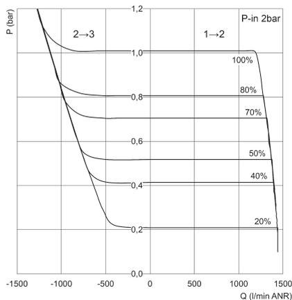
P = Geregelter Ausgangsdruck und Entlüftungsdruck
