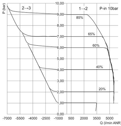
P = Geregelter Ausgangsdruck und Entlüftungsdruck
