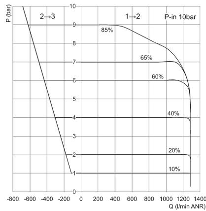
P = Geregelter Ausgangsdruck und Entlüftungsdruck
