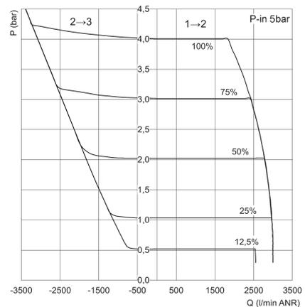
P = Geregelter Ausgangsdruck und Entlüftungsdruck
