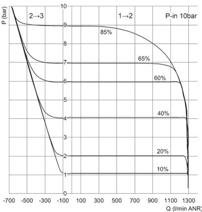
P = Geregelter Ausgangsdruck und Entlüftungsdruck
