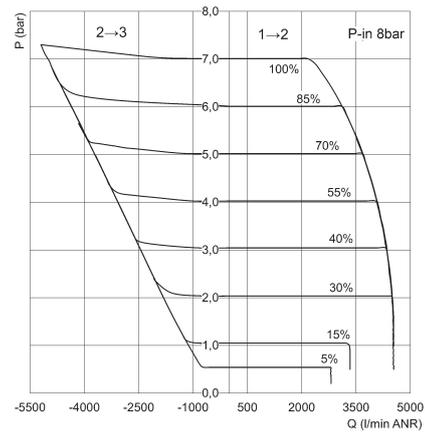
P = Geregelter Ausgangsdruck und Entlüftungsdruck
