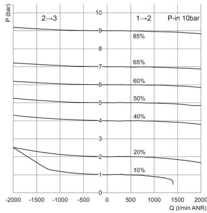
P = Geregelter Ausgangsdruck und Entlüftungsdruck
