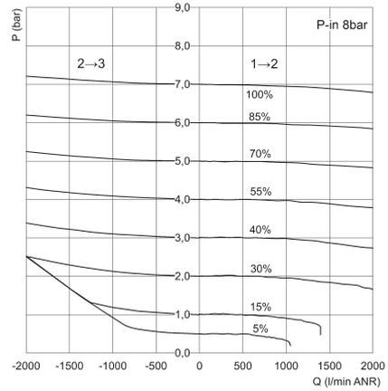
P = Geregelter Ausgangsdruck und Entlüftungsdruck
