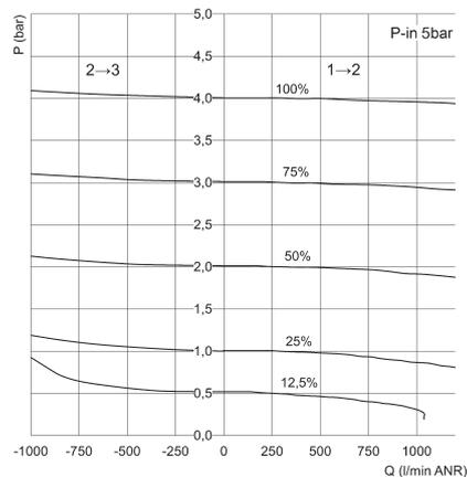
P = Geregelter Ausgangsdruck und Entlüftungsdruck
