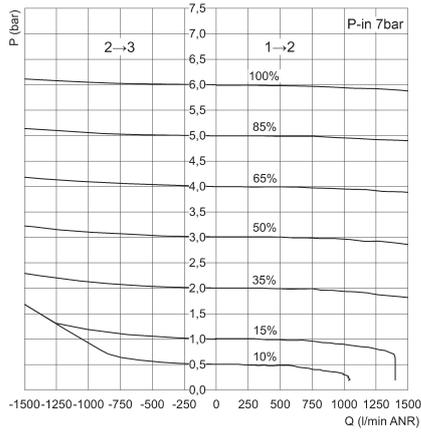
P = Geregelter Ausgangsdruck und Entlüftungsdruck
