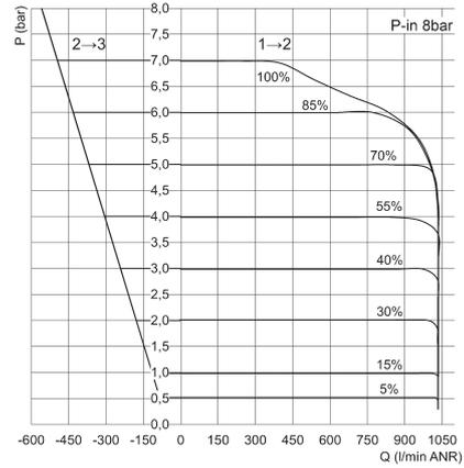
P = Geregelter Ausgangsdruck und Entlüftungsdruck
