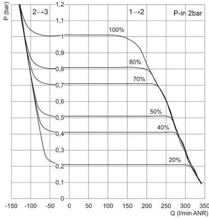
P = Geregelter Ausgangsdruck und Entlüftungsdruck
