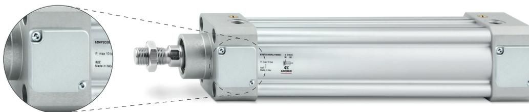
Déverrouillage manuel intégré: Retirez le couvercle (fig. A) et tirez sur la bague pour déverrouiller la tige (fig. B)
