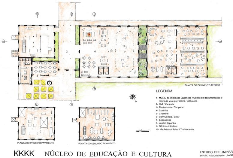
**Figura 26. Estudo preliminar do “KKKK Núcleo de Educação e Cultura”:** planta do pavimento térreo do conjunto (em cima) e do primeiro e segundo pavimentos do engenho (embaixo)
