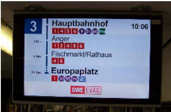
**Abbildung 41: Fahrgastinformation im Fahrzeug mit hochgerechneter Fahrzeit zu den nächsten Haltestellen**
