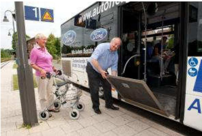
**Abbildung 36: Klapprampe zum einfacheren Ein- und Ausstieg bei der Saarbahn**
