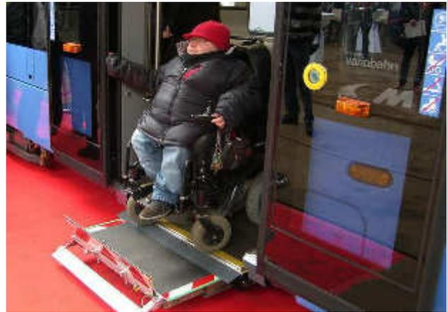
**Abbildung 37: Hublift an der ersten Tür einer Münchner Straßenbahn (hier bei einem Pressetermin)**
