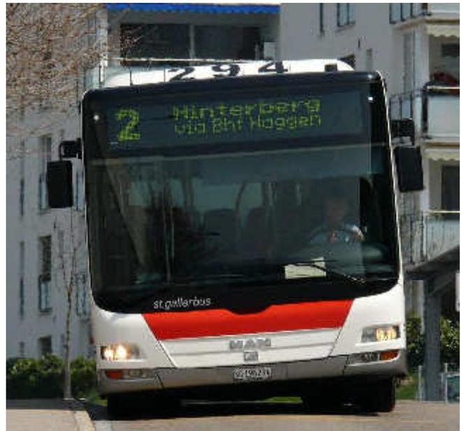
**Abbildung 35: Ein Bus in St. Gallen mit aktivem Kneeling an einer Haltestelle**
