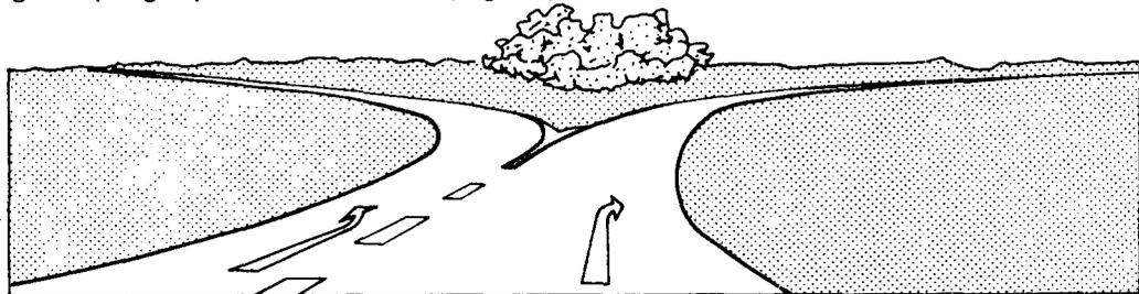
Fig. 15. Separación visual de dos direcciones divergentes
