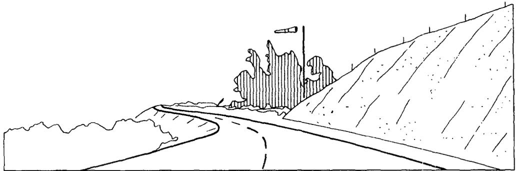
Fig. 18. Cortavientos a la salida de un desmante
