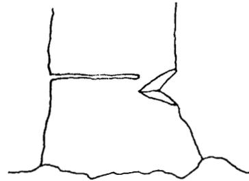
Fig. 38. Entalladura de caída y corte transversal
