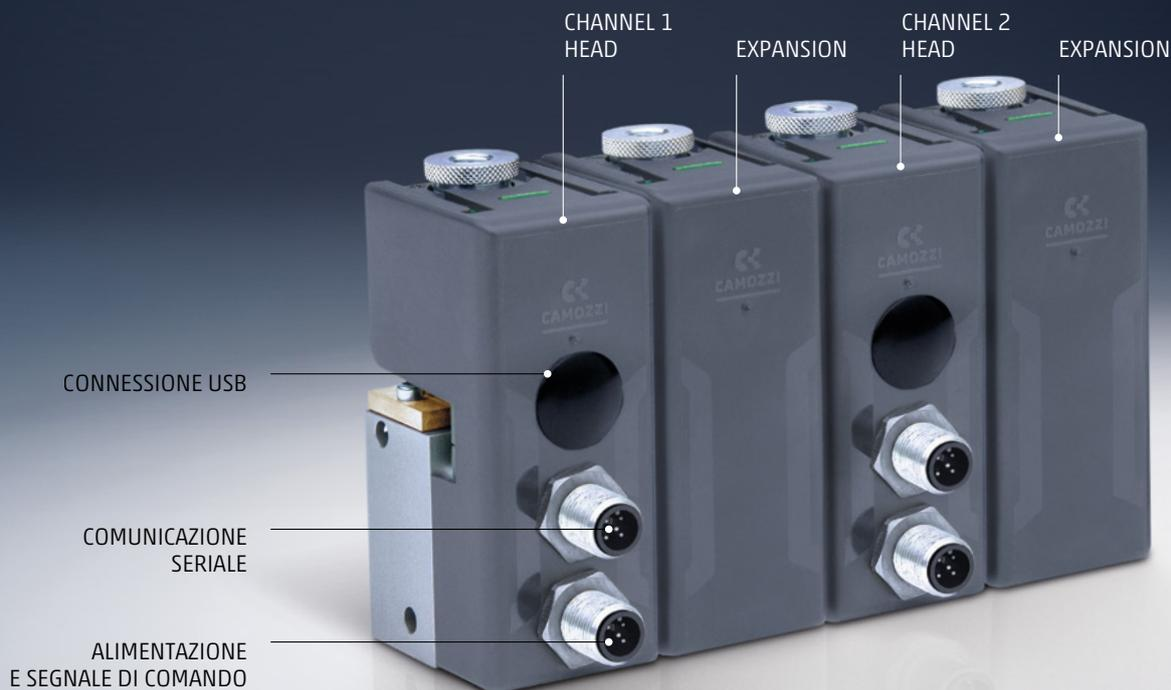
L'Open Frame Proportional Controller, adatto per applicazioni in ambito industry 4.0, fornisce un controllo di flusso, di pressione o di posizione in anello chiuso. Il sistema è costituito da due moduli: Head e Expansion che possono essere combinati singolarmente in base alle esigenze dell'applicazione.
