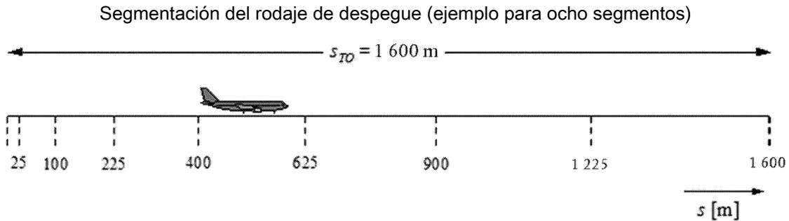
Al igual que sucede con los cambios de velocidad, el empuje del avión cambia a lo largo de cada segmento mediante un incremento constante  $\Delta P$ , que se calcula como:
