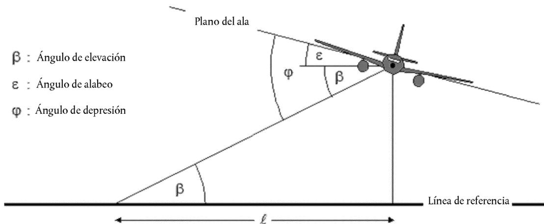
– El ángulo de elevación  $\beta$  (entre 0 y 90°) entre la trayectoria de la propagación sonora directa y la línea de tierra nivelada<sup>23</sup> determina, junto con la inclinación de la trayectoria del vuelo y el desplazamiento lateral  $\ell$  del observador a partir de la trayectoria en tierra, la atenuación lateral.
