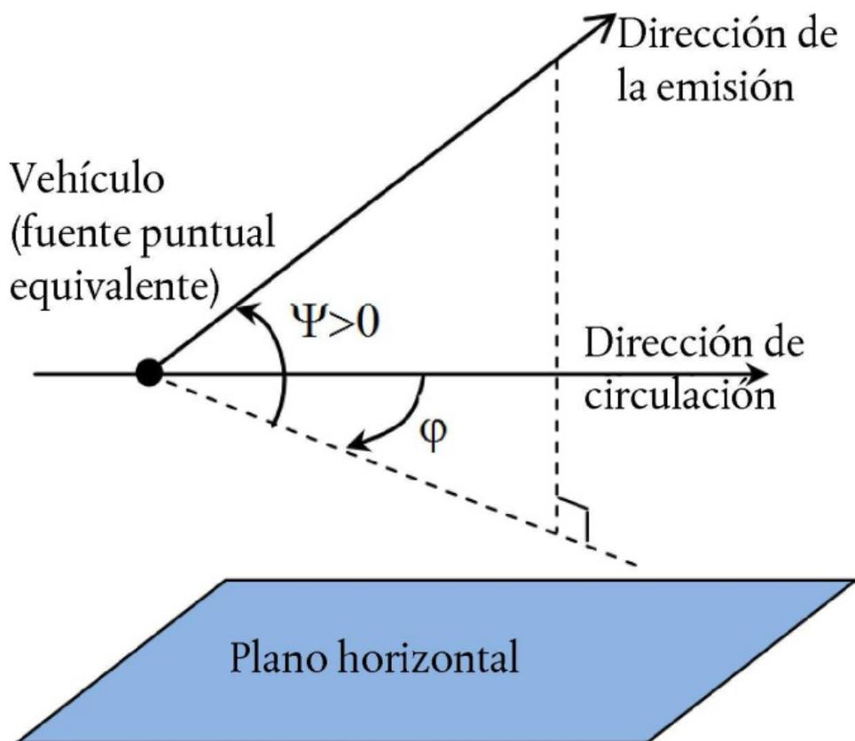
A efectos de cálculo, la potencia de la fuente se expresa de manera específica en términos de nivel de potencia sonora direccional por una longitud de 1 m de la vía  $L_{W',tot,dir,i}$  para tener en cuenta la directividad de las fuentes en su dirección vertical y horizontal, mediante las correcciones adicionales.
