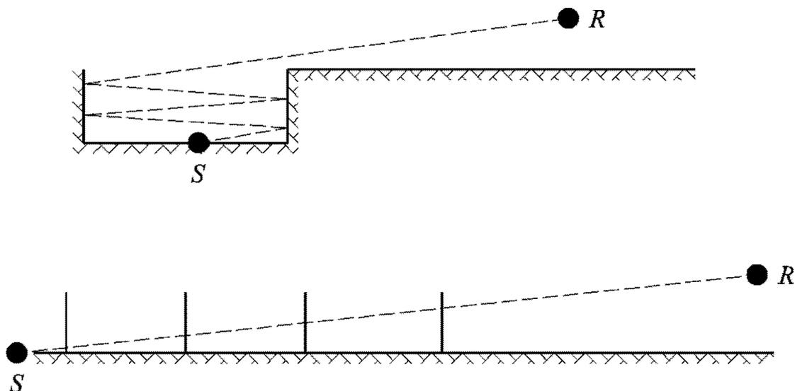
En esta representación, el rayo sonoro alcanza el receptor «pasando posteriormente a través de» los muros de contención de la zanja, que, por tanto, se puede comparar con las aperturas.
