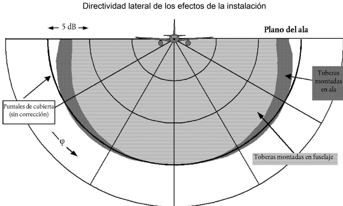
Se supone que  $\Delta_l(\phi)$  es bidimensional; es decir, no depende de ningún otro parámetro, y en particular que no varía con la distancia longitudinal al observador del avión. Esto significa que el ángulo de elevación  $\beta$  para  $\Delta_l(\phi)$  se define como  $\beta = \tan^{-1}(z/\ell)$ .
