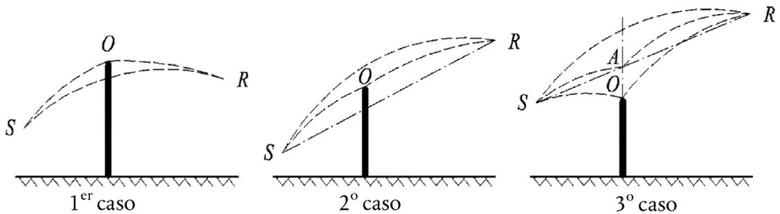
En condiciones favorables, se considera que los tres rayos de sonido curvados SO, OR y SR tienen un radio de curvatura idéntico  $\Gamma$  definido mediante:
