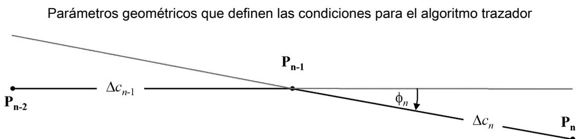
Se deben imponer determinadas restricciones para garantizar que la curva de nivel de ruido se calcula con un grado suficiente de precisión (véase la figura 2.7.v):
