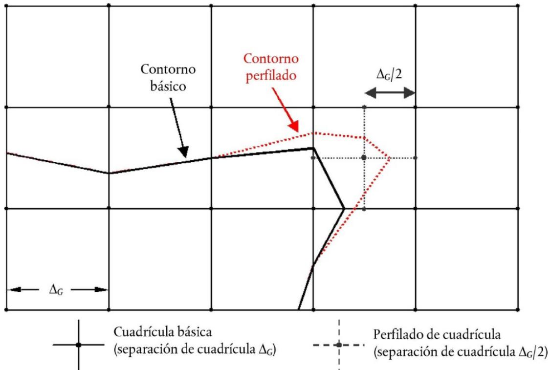
Una mejora importante en la eficacia del cálculo que ofrece resultados más precisos es utilizar una cuadrícula irregular para ajustar la interpolación en celdas importantes. La técnica, ilustrada en la figura 2.7.s, consiste en reforzar la malla localmente, dejando invariable la mayor parte de la cuadrícula. Se trata de una operación muy sencilla, que se consigue con los siguientes pasos:
