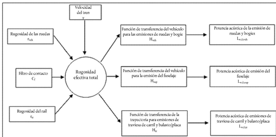
Se utilizará una velocidad mínima de 50 km/h (30 km/h para los tranvías y el metro) para determinar la rugosidad efectiva total y, por consiguiente, el nivel de potencia sonora de los vehículos (esta velocidad no afecta al cálculo de las circulaciones de vehículos) para compensar el error potencial introducido por la simplificación de la definición del ruido de rodadura, el ruido de los frenos y el ruido de impacto generado en las intersecciones y los cambios.
