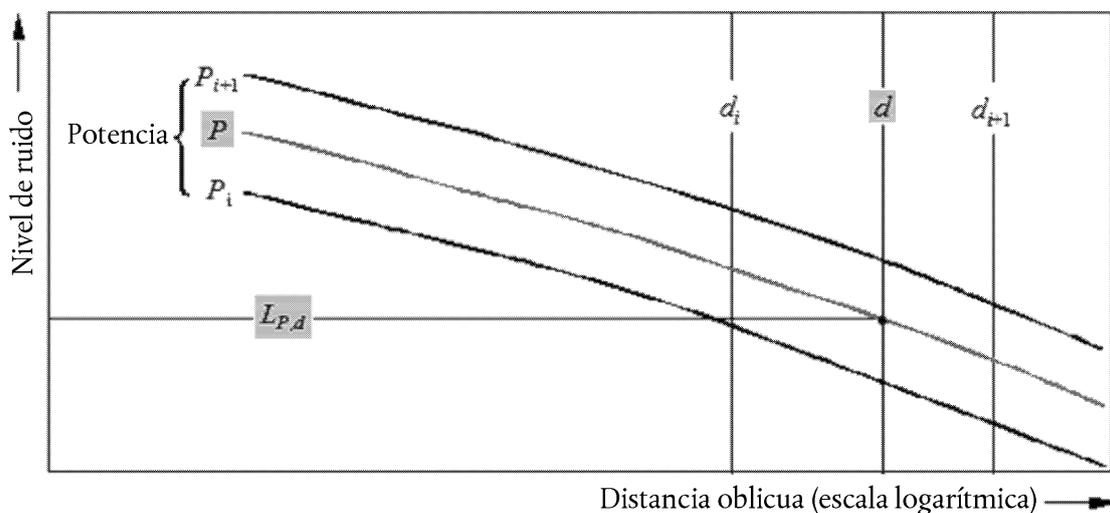
Si  $P_i$  y  $P_{i+1}$  son valores de potencia del motor para los que se tabula el nivel de ruido con respecto a los datos de distancia, el nivel de ruido  $L(P)$  a una distancia determinada para la potencia intermedia  $P$ , entre  $P_i$  y  $P_{i+1}$ , resulta de:
