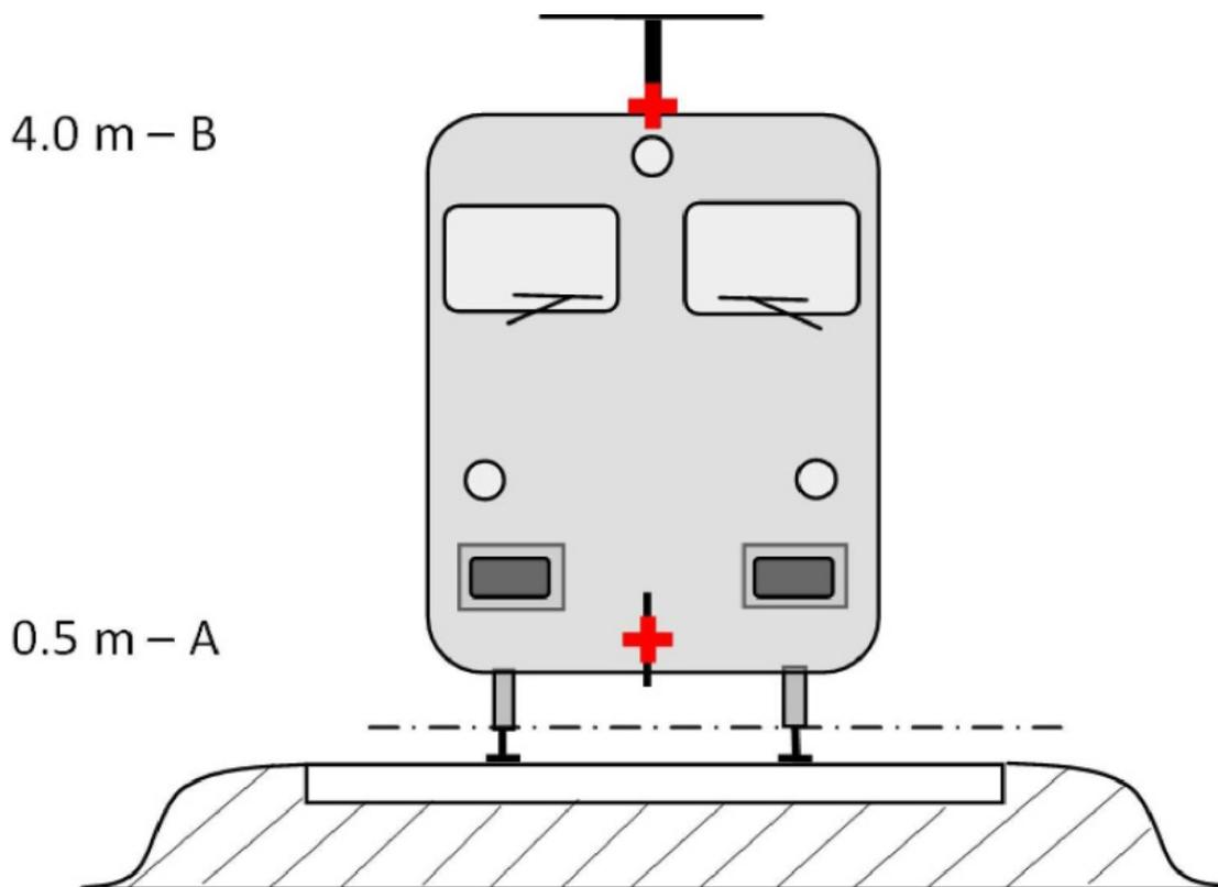
Las distintas fuentes lineales de ruido equivalentes se ubican a diferentes alturas y en el centro de la vía. Todas las alturas se refieren al plano tangencial a las dos superficies superiores de los dos carriles.
