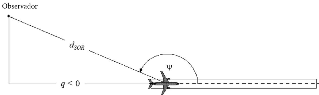
La función  $\Delta_{SOR}$  representa la variación del ruido total que produce el desplazamiento en tierra firme antes del despegue medido detrás el punto de partida de rodaje, en relación con el ruido total del desplazamiento en tierra firme antes del despegue medido en el lateral del punto de partida de rodaje, a la misma distancia:
