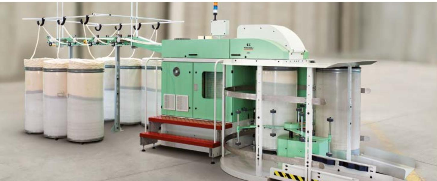
Il DF1, per il primo passaggio, e il DFR1, con autoregolatore per il secondo passaggio, sono gli stiratoi Marzoli mono-testa ad alte performance. Progettati per eccellere su qualità dell'output e produttività, questi stiratoi garantiscono velocità di produzione fino a 1.000 m/min con alta regolarità del nastro.
