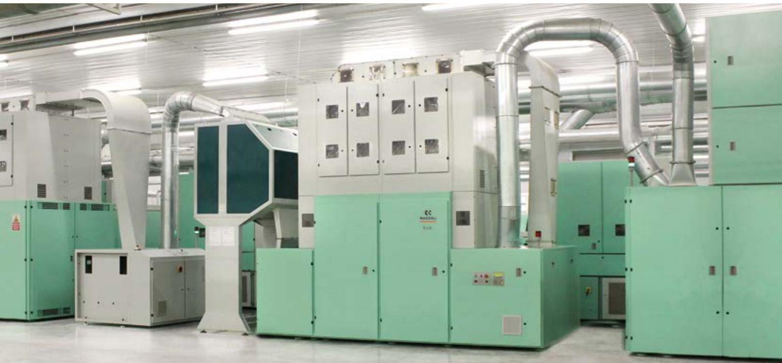
Quattro o otto celle di mischia con ulteriore mischia intima del materiale nel canale a mezzo aspirazione e livelli di produzione fino a 1.600 kg/h.
