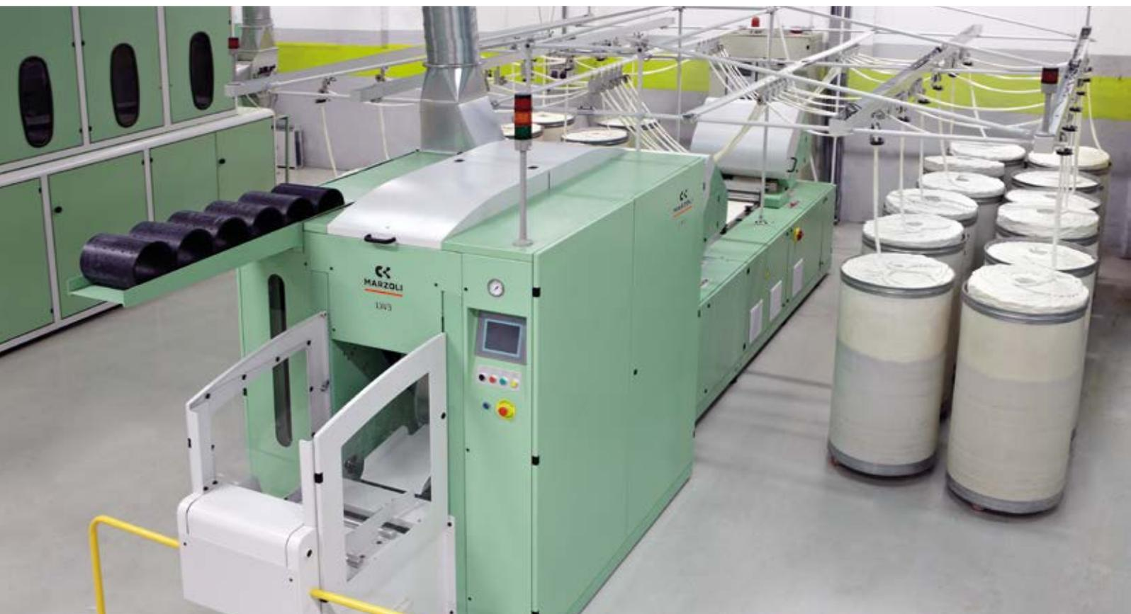
Lo stiroriunitore LW3 rappresenta la miglior tecnologia per qualità e produttività. Il design innovativo della zona di formazione della teletta con 4 calandre e un cilindro compattatore per evitare l'espansione degli strati durante la formazione consente di raggiungere una velocità media di 190 m/min. Questo, insieme ad una levata automatica di soli venti secondi, consente di produrre fino a 620 kg/h di teletta
