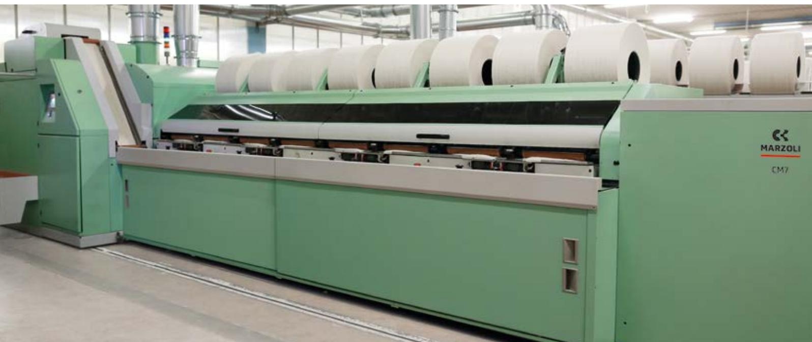
Pettinatrice con 8 teste, cambio vaso automatico e tecnologia di riattacco automatico della teletta. Grazie alla velocità variabile del pettine circolare e la revisione della cinematica della pinza, la macchina può raggiungere 600 colpi al minuto, consentendo produzioni fino a 85 kg/h.
