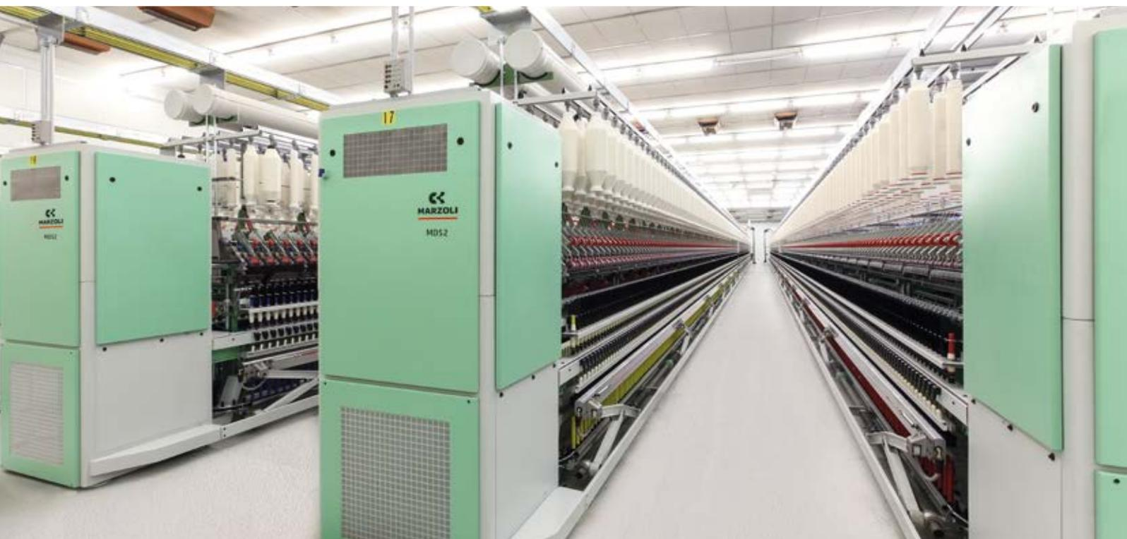
I filatoi Marzoli, l'MDS2 e l'MP1N, sono macchine elettroniche con comandi indipendenti per fusi, carro porta-anelli e gruppo stiro. Possono raggiungere rispettivamente i 1.824 e i 1.632 fusi con due opzioni di scartamento: 70 mm, con anelli di diametro fino a 48 mm; 75 mm per anelli con diametro fino a 54 mm. Per i fusi, l'MDS2 ha un'unica cinghia tangenziale con un motore ogni 96 fusi.
