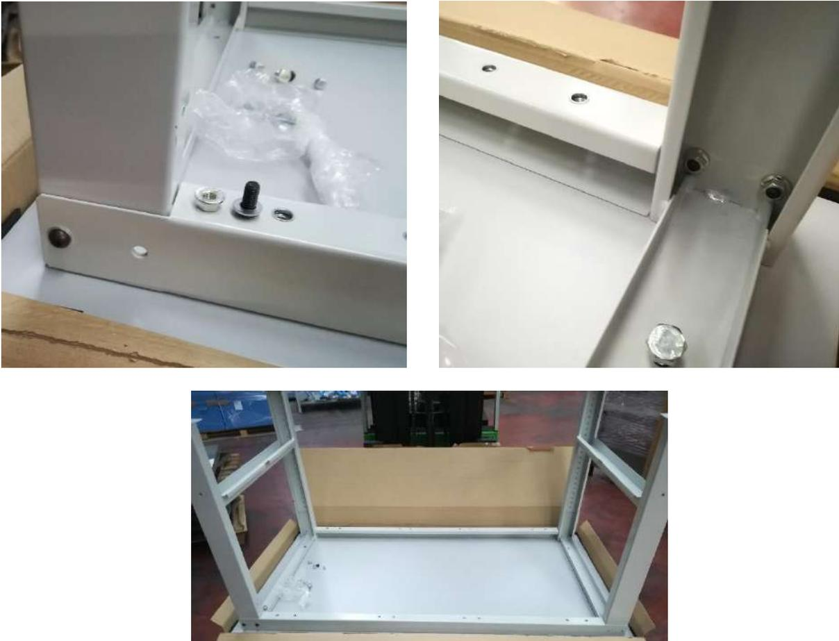
**Figura 3: Fissaggio collegamenti alle gambe.**
