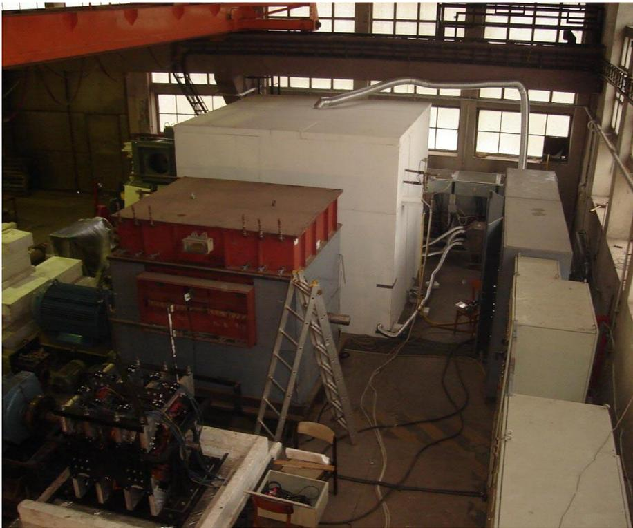
Blick von oben auf die Testanlagen in der Industriehalle von Gamma Manager. Nahe am Fenster steht die styroporverkleidete Anlage EBM 720 E, davor die Anlage EBM 720 K, bei der im oberen Bereich der Kühlbehälter mit den verschiedenen Rohrleitungsanschlüssen zu sehen ist. Links vorne ist der Antriebsmotor und die geöffnete C4/4-Maschine zu erkennen. Rechts befinden sich die elektrischen Schaltschränke für die einzelnen Anlagen.
