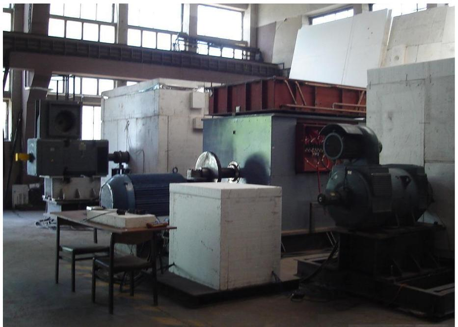
Im Vordergrund im Styroporgehäuse ist die kleine Maschine des Typs BB-LEGO eingebaut, die von einem kleinen Antriebsmotor (dahinter, nicht sichtbar) angetrieben wird. Am rechten Rand daneben ist die grosse Styroporverkleidung zur exakten kalorimetrischen Messung der thermischen Leistung der darin aufgebauten C4/4-Maschine zu sehen.
