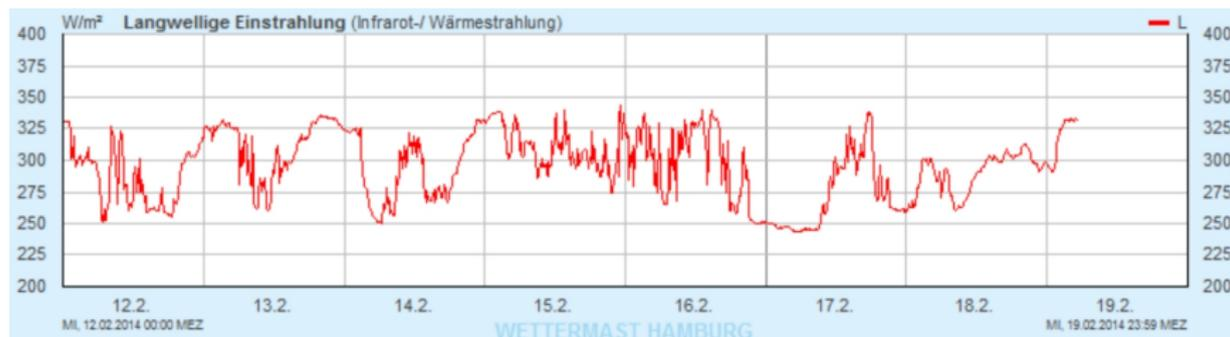
Die Gesamtwärmestrahlung ist die Summe von Globalstrahlung und Gegenstrahlung. Deswegen ist es tagsüber bei Wolkenbedeckung kühler und nachts wärmer als ohne Wolken.
